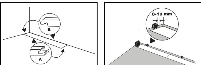
Sıranı quraşdırarkən lövhələri aşağıdakı şəkildə uzununa düzün: birinci və növbəti hər bir lövhənin yanına təzəsini qoyaraq onu təpə ilə artıq yerləşdirilmiş lövhənin pazına bucaq altında yerləşdirin. Bundan sonra quraşdırılan lövhəni döşəmənin üzərinə tam uzadılanadək qoyun.
