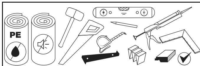
3. Tikişsiz və ya mineral əsaslı döşəmələr tam olaraq suya davamlı olan polietilen plynoka ilə örtülməlidir. Bu halda örtüyün qovuşuq yeri ən azı 200 mm üst-üstə düşməlidir. Həmçinin bütün əsaslar üçün səsi izolyasiya edən alt örtüklər tövsiyə olunur. Səsi izolyasiya edən alt örtüklər bir-birinə qovuşuq, yəni üst-üstə düşmədən quraşdırılır.
