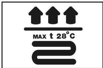
Əgər qızdırıcının istehsalçısı temperaturun 28 ° C-dən yuxarı heç zaman artmayacağını təmin edirsə, tənzimlənən plynokalı elektrik qızdırıcısı ilə olan döşəmələr laminat döşəmələrlə birgə istifadəyə yararlı ola bilər. Plyonkalı elektrik qızdırıcısı əsasında olan standart isti döşəmələr, temperaturun kəskin dəyişməsi zamanı döşəmənin üst qatının 28 °C yuxarı qızmasını təmin edir, və ona görə də üzərində laminatın quraşdırılması üçün yararsız sayılır.
