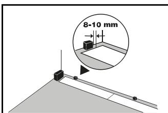
8. Bütün qapı çərçivələrində, keçidlərdə, mürəkkəb konfiqurasiyalı otaqlarda, həmçinin eni və uzunluğu 10 m çox olan otaqlarda qapı altlıqları qoymaq tövsiyə edilir.
