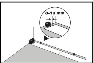
Montuokite eilę jungiant grindlentes skersinėmis pusėmis sekančiu būdu: prie pirmos ir kiekvienos sekančios paklotos grindlentės pridėkite naują, kampu įvedant jos įlaidą į jau pakloto elemento išdrožą. Po to leiskite klojamą grindlentę žemyn, kol padėsite ją lygiai ant grindų.
