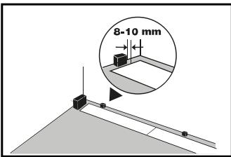
地板横边相接一排拼装顺序如下：铺设第一地板以后、随后的每一地板附上新一板、在一定的角度下将其放入已经铺装组件的卡槽中。随后将铺设的地板放下、直到完全放平到地板上。
