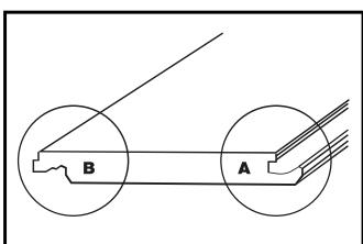
从房屋的远左角开始铺装。铺装时、地板的凸榫（B）两方应针对墙壁。开始安装的时候、请装好保持枪毙间隙的撑板。
