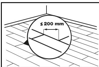
3. 第二和随后所排的拼装、开始自相互连接地板的侧面。
