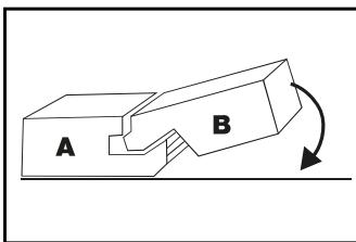
2. 在第一排的最后一个地板上两处需要的长度、根据标志锯掉组件。第二排应该从第一排最后一地板的剩余开始、但如果其长度不大于200mm。随后所有排的铺设 应该从上一排剩余的地板开始。
