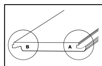
به سمت (B) نصب کفپوش ها را از گوشه سمت چپ اتاق شروع کنید. در شروع فرآیند نصب شانه دیوار گذاشته می شود. جهت تعیین و مشخص نمودن میزان فاصله مورد نیاز از دیواره ها بست ها در محل خود قرار دهید.
