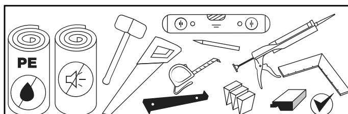
3. روی سطح کف مورد نظر پیش از نصب کفپوش می بایست بوسیله ورق پلی اتیلن ضد آب پوشیده شود. در این صورت ورقه پلی اتیلن حداکثر ضخامتی را، که تحت پوشش قرار می دهد ۰۰۲ میلیمتر می باشد. همچنین پوشش کف بوسیله عایق صوتی پیش از نصب کفپوش توصیه می گردد. عایق صوتی با ورق پلی اتیلن ضد آب وصل می کند یعنی بدون همپوشانی قرار می گیرد.
