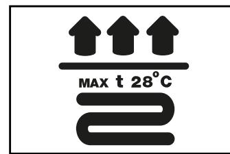
در صورتی می توان از کفپوش های تولیدی در پوشش کف های دارای سیستم گرمایشی با قابلیت کنترل میزان حرارت استفاده نمود، که درجه حرارت آن هیچگاه بر روی درجه حرارت بالای ۸۲ درجه سانتیگراد تنظیم نگردد. سیستم های گرمایشی الکتریکی کف بطور استاندارد دمای کف را کمی بیش از ۸۲ درجه سانتیگراد گرم می کنند به همین دلیل برای نصب کفپوش های تولیدی ما نامناسب می باشند.
